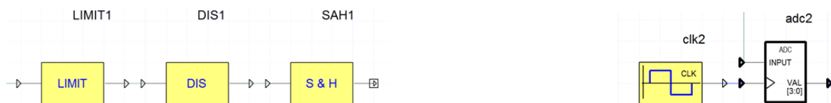
Abb. 4: Modellierung von A/D-Wandlern, links mit einzelnen Bibliothekselementen, rechts mit modifizierten VHDL-AMS-Komponenten
