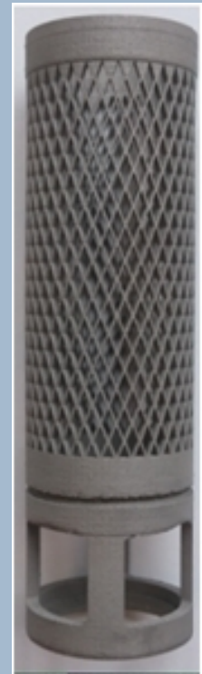
Links: Beispiel für die Optimierung einer Lattice-Struktur: die Originalgeometrie führt nicht zu dem gewünschten Ergebnis.
