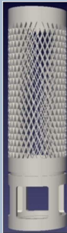
Links: Beispiel für die Optimierung einer Lattice-Struktur: die Originalgeometrie führt nicht zu dem gewünschten Ergebnis.
