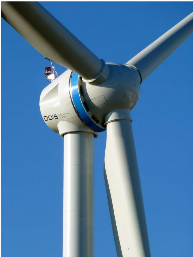
Bild 1: Axialflussgenerator integriert in einer Windkraftanlage.
